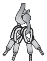
Manille à écrou et goupille
